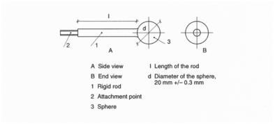
Figure A.1. Test rod
